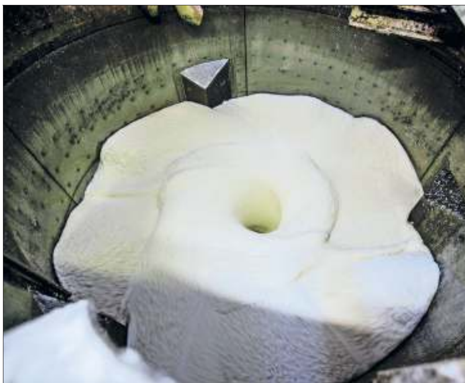
Aus diesem Faserstoff-Wasser-Brei wird einmal hochwertiges, weißes Papier
