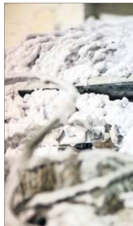
Zellstoff-Wasser-Brei klebt an den Maschinen
